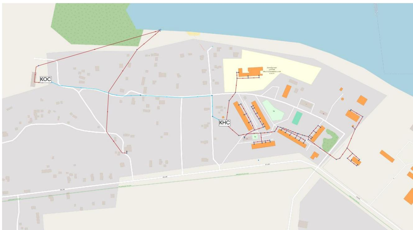
**Рисунок 8 Сети централизованной системы водоотведения (синим цветом представлен напорный участок, красным – самотечные)**
